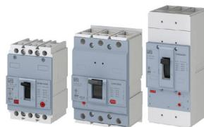
Los interruptores DWB son desarrollados para protección de circuitos eléctricos (hasta 690 V ca o 250 V ce), generadores y motores en un amplio rango de corrientes nominales de 16 hasta 400 A, todos de acuerdo con la norma IEC 60947-2.
